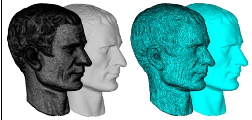
(a) 42만개의 삼각형 (b) 3만개의 삼각형 그림 1.14 표면 삼각형 조대화 기능 적용 사례.
